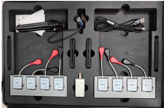
图 13 YW-Wireless 无线表面肌电测试系统
