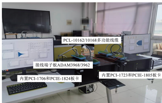
图 7 基于 LabVIEW 的半实物仿真平台
