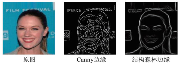
图 2 Canny 边缘和结构森林边缘对比图
