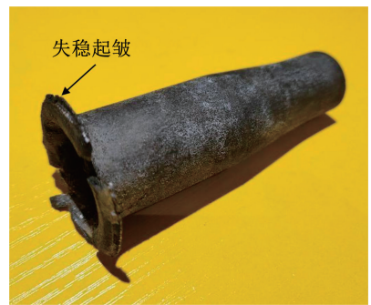
图 18 某规格 2A12 铝合金热挤压拉杆典型起皱缺陷
