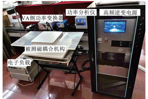
图 6 磁耦合机构互操作性测试平台
