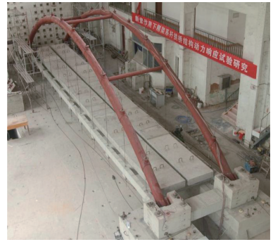
图 4 系杆拱桥断索试验模型
