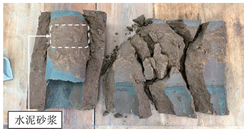
(a) 水泥砂浆芯桩
