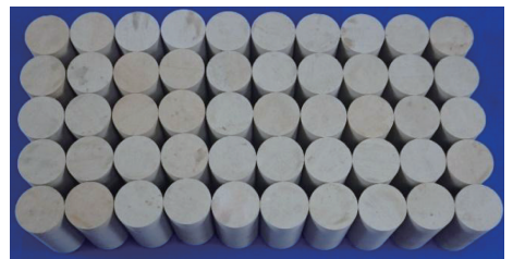
图 1 试验用圆柱体砂岩试样
