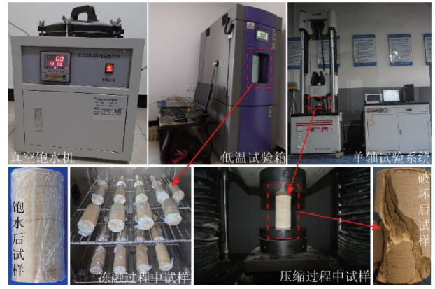
图 2 部分试验设备及试验过程图示
