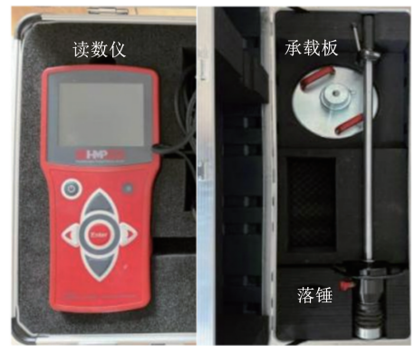
图 3 动态变形模量测试仪
