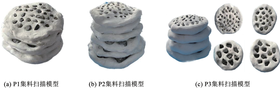
图 2 集料 CT 扫描模型实物照片
