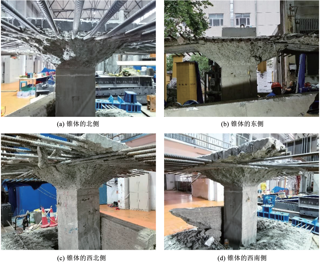
图9 试件 PMS-3 的冲切锥体
