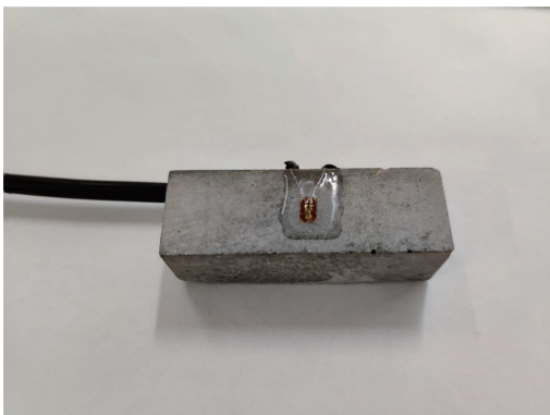
图 7 应变砖成品实物
