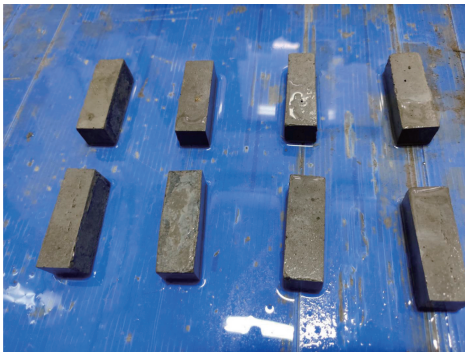
(a) 应变砖浇筑凝结
