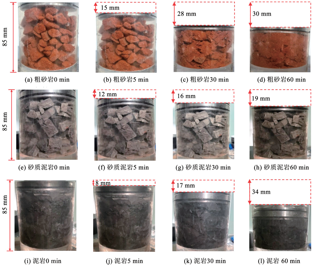
图 4 压实全过程中 3 类破碎岩体压实图像
