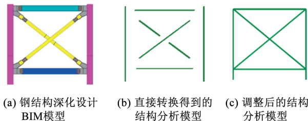
图 4 构件轴线不相交问题与调整方法
