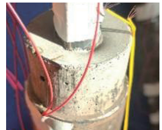
图 5 灌浆料断裂滑移
