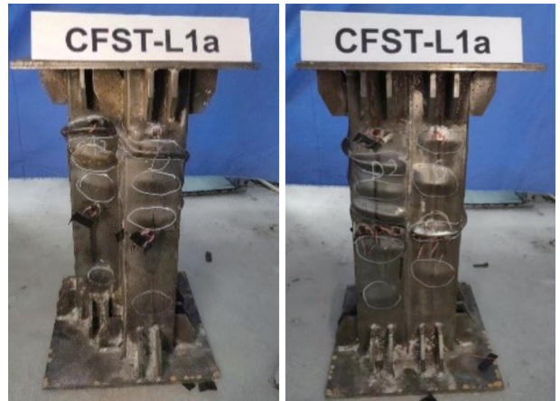
图 5 CFST-L1a 整体破坏
