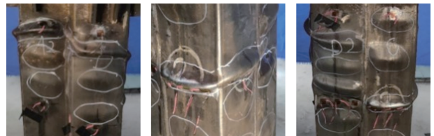
图 6 CFST-L1a 局部破坏
