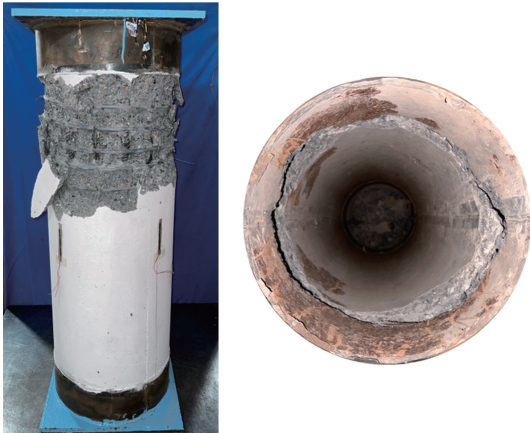
图 9 空心钢筋混凝土试件破坏现象
