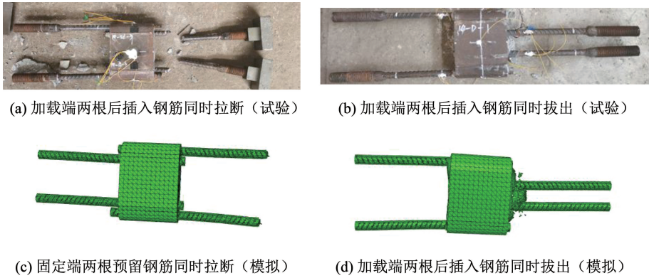
图 20 试验和模拟典型破坏形式对比
