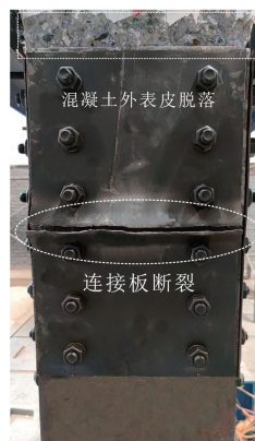
图 7 试件破坏形态
