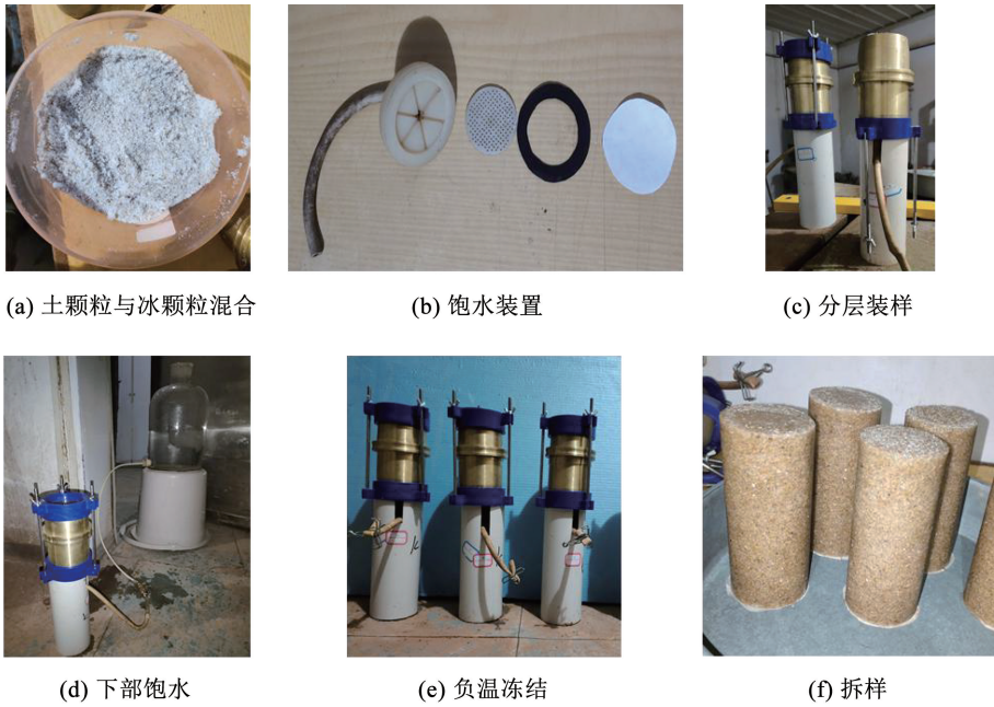
图 1 高含冰量砂土试样制样过程
