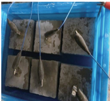
(b) 混凝土试块腐蚀
