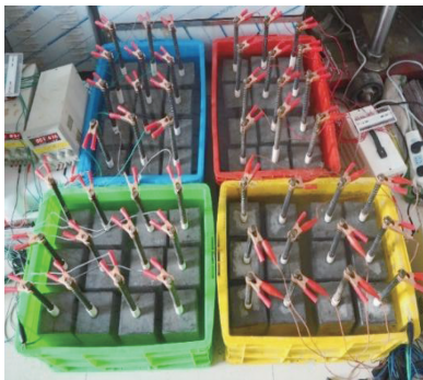
(a) 钢筋混凝土试件腐蚀
