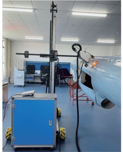
图 12 机器人激光除漆现场
