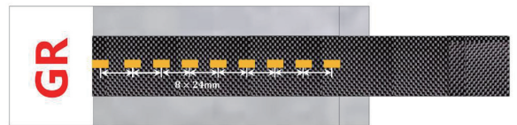
图 4 单剪试件应变片粘贴示意
