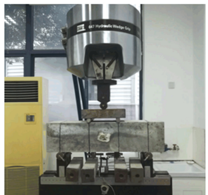
图 1 四点弯曲试验装置
