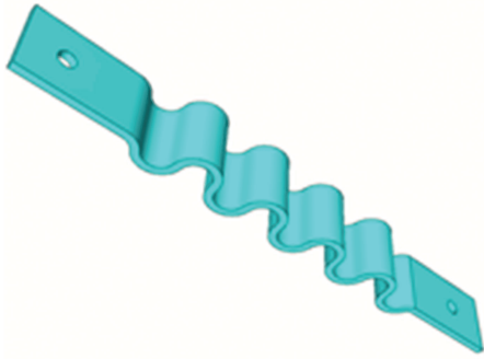
图 3 波纹钢板耗能元件示意图
