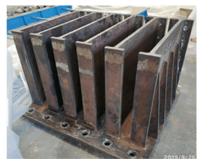
(c) 防落梁框架实物图
