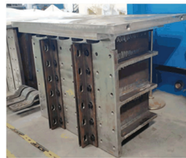
(b) 梁底挡块实物图
