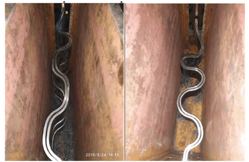
(a) 拉伸 150 mm 的波纹钢 (b) 压缩 150 mm 的波纹钢
