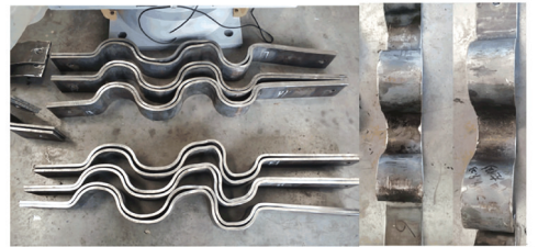
(c) 疲劳试验后 12 片金属波纹钢板试件图
