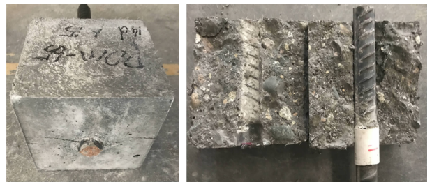
(b) POM-14-2.6: 拔出破坏
