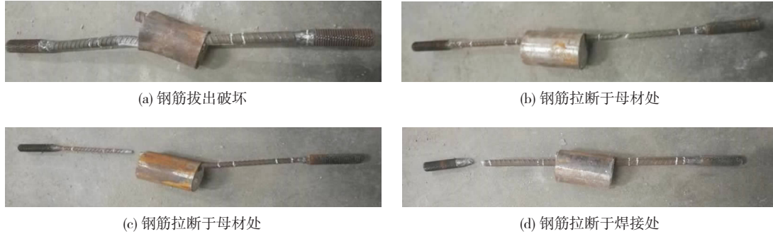
图 6 试件破坏情况
