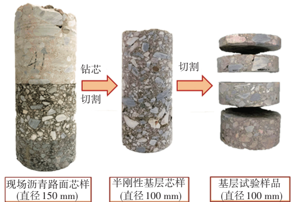
图2 半刚性基层试验样品制备过程
