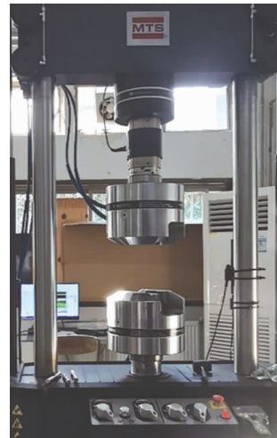
图 4 复合钢筋低周疲劳试验设备
