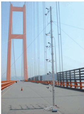
(a) 桥面风速仪沿高度布置
