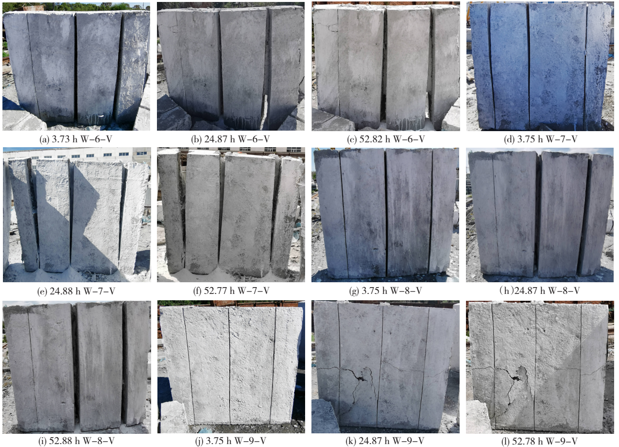
图 8 垂直于墙片顶面竖向打孔并注入静态破碎剂后墙片的侧面破碎过程
