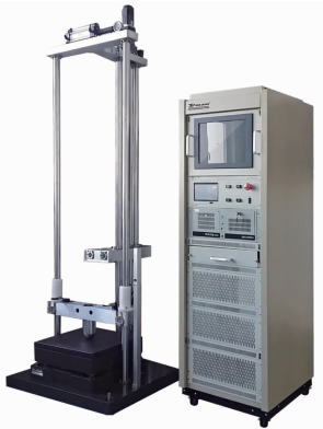
图 3 DP-1200 型全自动落锤冲击试验机 Fig. 3 DP-1200 fully automatic drop hammer impact testing machine
