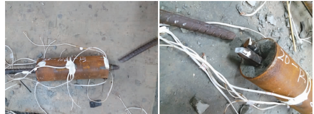
(a) 后插入钢筋拉断 (b) 加载端(后插入端)灌浆料脱落
