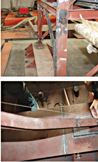
图4 震后支撑的残余变形
