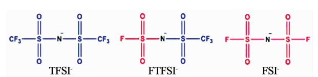
图 2 TFSI、FTFSI 和 FSI 阴离子的结构式 [16] Fig. 2 Structures of TFSI, FTFSI, and FSI anions [16]
