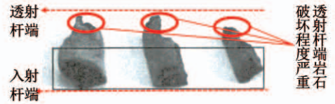
图 8 透射杆端矿石破碎程度高于入射杆端矿石 [21]
