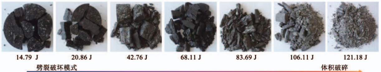
图 11 不同耗散能下的磁铁矿石冲击破碎形态
