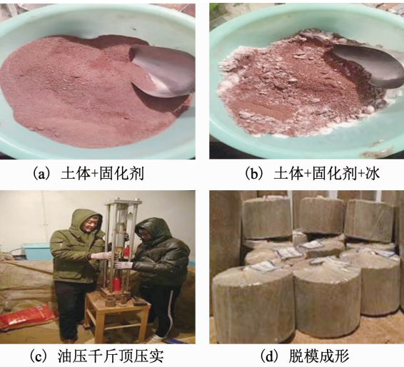
图 1 固化土样制样过程 Fig. 1 Process for solidification soils
