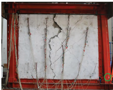
(b) 地聚物混凝土墙体及柱脚损伤(1/26 位移角)
