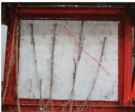
(a) 地聚物混凝土墙体开裂(1/36 位移角)
