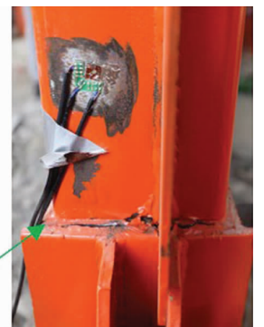
(b) 地聚物混凝土墙体及柱脚损伤(1/26 位移角)
