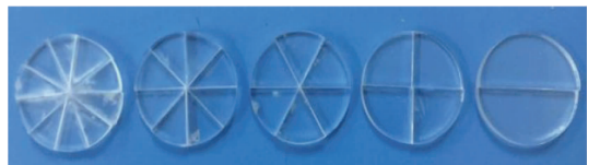
图 2 制备扇形凹凸相间节理模具
