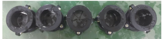
图 1 制备水泥砂浆试样模具
