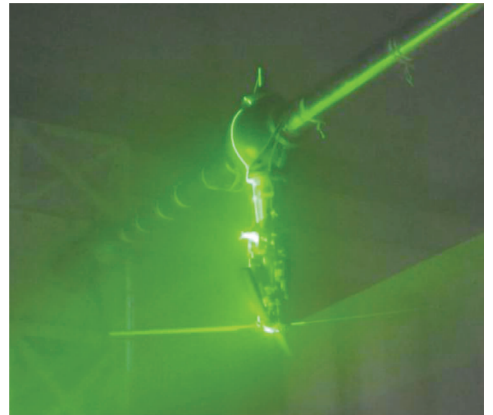
图 2 \Phi 5 m 立式风洞旋翼模型 PIV 试验照片
