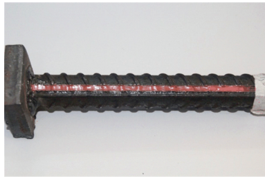
(b) 涂抹氯丁胶和植筋胶封槽后
