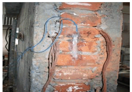
图 10 砖墙粘贴应变片
