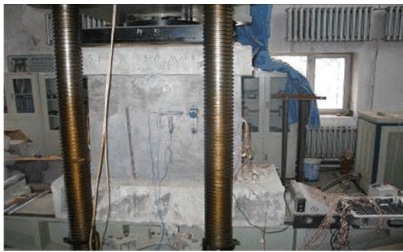
图 12 混凝土板墙加固砖墙轴压试验
