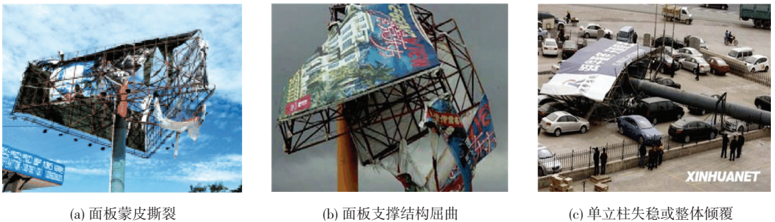
图 1 大型户外广告牌的 3 种典型风灾破坏模式
