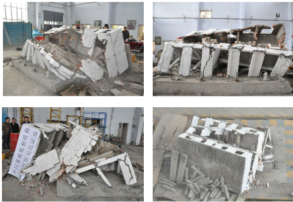
(b) 有翼墙模型废墟
