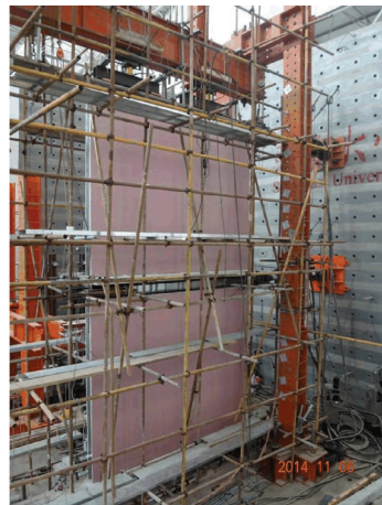
图 9 双层组合墙体抗剪试验
