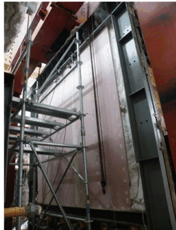
图5 冷成型钢承重组墙体足尺耐火试验
