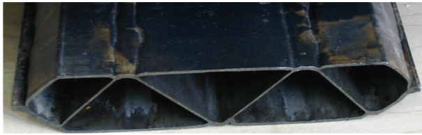
图 12 Ti 2 AlNb 合金 3 层结构 SPF/DB 样件
