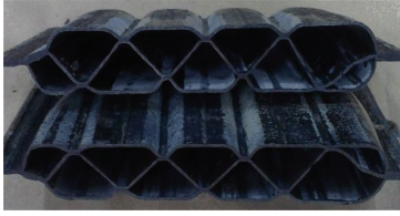
图 11 Ti 2 AlNb 合金 3 层结构 SPF/DB 样件
