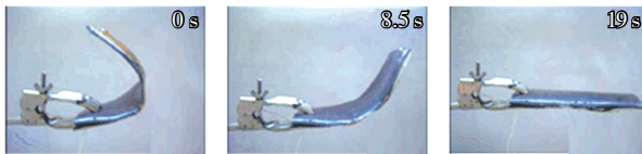
图 27 基于形状记忆聚合物的可展开蒙皮结构 [47]
