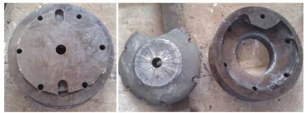
(a)凹模底部裂纹 (b)完全断裂
