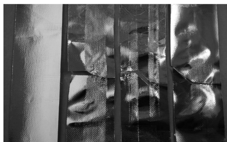
(a) 试验前 (b) 试验后单边切口试样 (c) 试验后中心切口试样 (d) 试验后单边斜切口试样
