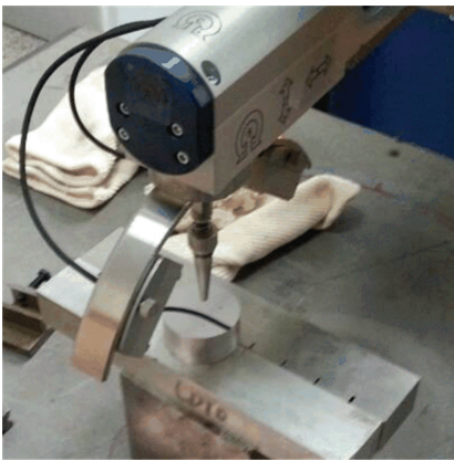
图9 残余应力测试
